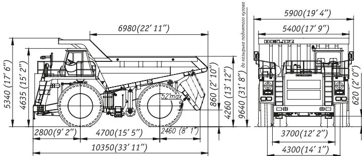
Габаритные размеры указаны для базовой комплектации машин.
